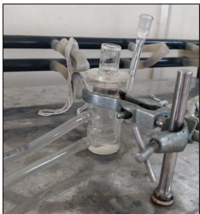
Figure 25. Ex-vivo Franz diffusion apparatus
